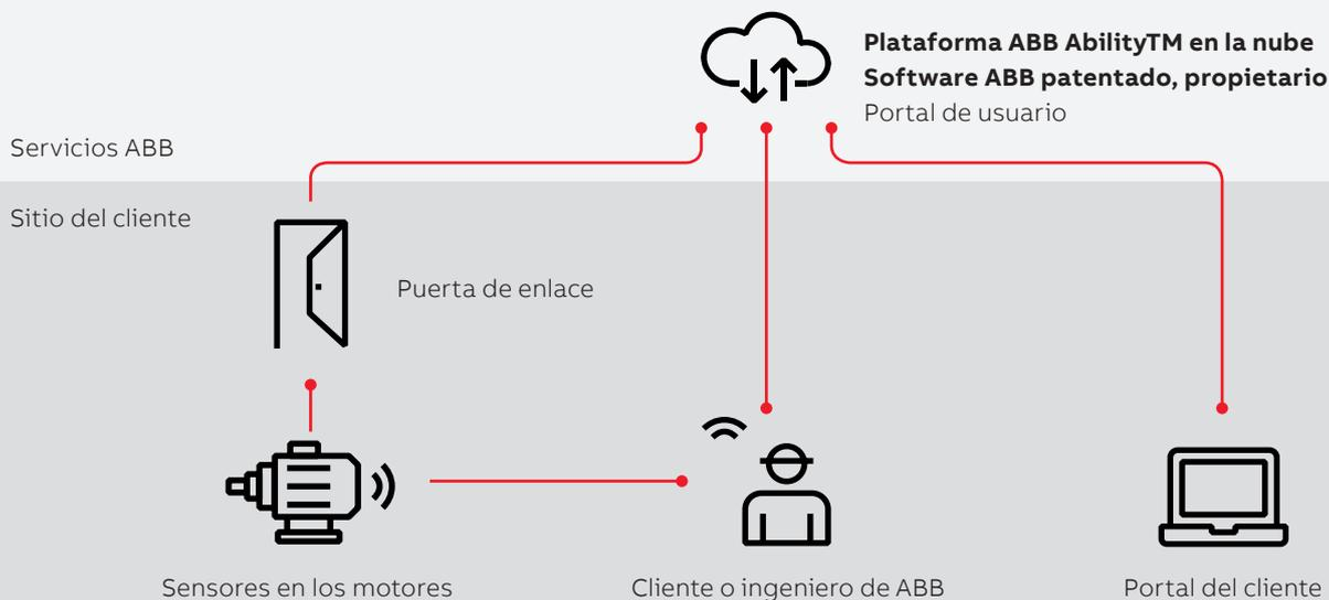
La solución de monitoreo de condición ABB para motores de baja tensión. ABB Ability™ Smart Sensor transmite datos a través de un teléfono inteligente o puerta de enlace ABB gateway a un servicio en la nube seguro. Los algoritmos en la nube analizan los datos y los convierten en información relevante, que luego se envía al teléfono inteligente del usuario y al portal del cliente.
